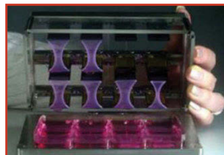
Figura 5 - Forza contrattile sviluppata dai fibroblasti - Sistema GlasBox
